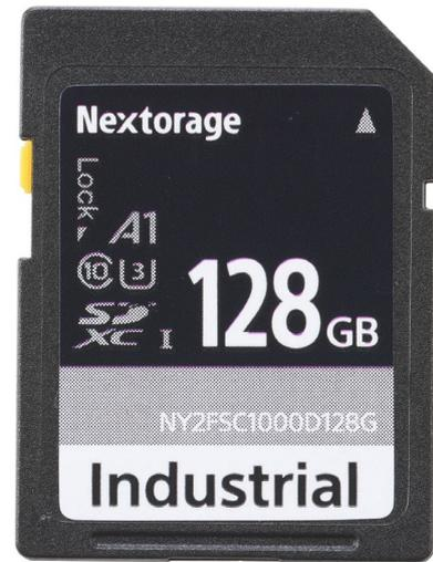
Nextorage Y2シリーズは、3D TLC NANDを搭載した高い電断耐性と幅広い動作温度範囲に対応したSDカードです。組み込み機器の制御ボードやエッジコンピュータ、IoT機器、監視カメラ等、産業用途を中心にOS、アプリケーションのブート用メディアとして、またログや映像記録等のデータストレージとしてご使用頂けます。
