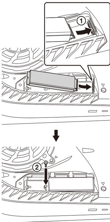
6. Insérez l'extrémité du couvercle du logement d'extension du M.2 SSD dans la PS5 (①), puis alignez le couvercle avec l'orifice de vis, maintenez-le en place et fixez-le avec la vis que vous avez retirée à l'étape 2 (②).
