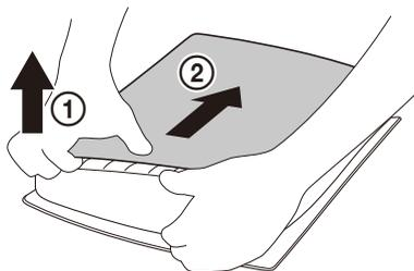
2. 用十字螺丝刀 (#1) 卸下螺丝，然后取下 M.2 固态硬盘拓展槽的盖子。
