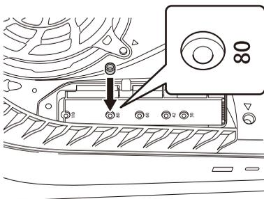
5. 把固态硬盘插入 M.2 固态硬盘拓展槽接口 (①), 注意不要挪动垫环的位置。把接口的另一边和螺丝孔位置对齐, 按下去, 用第 3 步中取下的螺丝固定位置 (②)。
