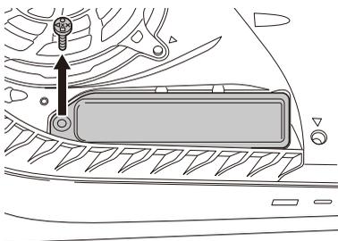
3. 卸下 M.2 固态硬盘的固定螺丝和附着在 PS5 上的垫环 (i)。
