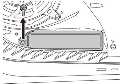
3. Entfernen Sie die M.2-SSD-Montageschraube und die Zwischenscheibe (i), die an der PS5 angebracht sind. Hinweis: Achten Sie darauf, die Schraube und die Zwischenscheibe nicht zu verlieren.
