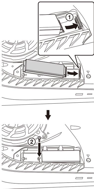
6. 将 M.2 固态硬盘拓展槽盖板的一端插入 PS5 (①), 然后将盖板与螺丝孔对齐, 按下去, 用第 2 步中取下的螺丝拧紧固定 (②)。
