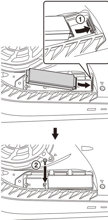
6. Stecken Sie das Ende der Abdeckung des M.2-SSD-Erweiterungssteckplatzes in das PS5 (①), richten Sie die Abdeckung am Schraubenloch aus, halten Sie sie fest und befestigen Sie sie mit der in Schritt 2 entfernten Schraube (②).
