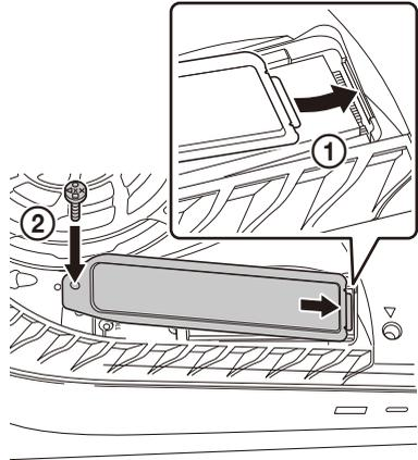
7. Bringen Sie die Blende der PS5 an. Richten Sie die Haken an der Blende auf die Befestigungspositionen an der PS5 aus und verschieben Sie die Blende dann, um sie anzubringen.
