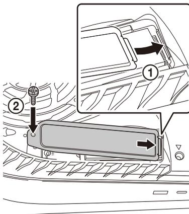
7. Fixez le panneau de la PS5. Alignez les crochets du panneau avec les positions de fixation sur la PS5, puis faites glisser le panneau pour le fixer.
