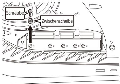
4. **Setzen Sie die in Schritt 3 entfernte Zwischenscheibe in das mit „80“ markierte Schraubenloch ein.**
