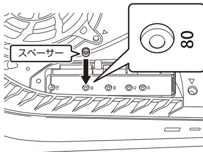
5 スペースが動かないように注意して、本機をM.2 SSD拡張スロットのコネクタに差し込み (①)、コネクタの反対側をネジ穴に合わせて押さえ、手順3で取り外したネジで固定します (②)。
