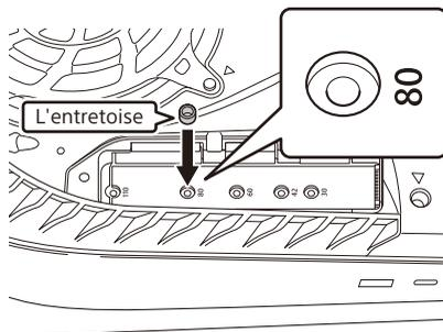
5. En veillant à ce que l'entretoise ne bouge pas, insérez le SSD dans le connecteur du logement d'extension du M.2 SSD (①), puis alignez l'extrémité opposée au connecteur avec l'orifice de vis, maintenez-la en place et fixez-la fermement avec la vis que vous avez retirée à l'étape 3 (②). Un serrage excessif de la vis risque d'endommager le SSD ou le logement d'extension du M.2 SSD.
