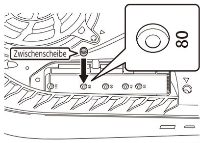
5. Achten Sie darauf, dass sich die Zwischenscheibe nicht bewegt, setzen Sie die SSD in den Anschluss des M.2-SSD-Erweiterungssteckplatz-Anschlusses ein (①) und richten Sie dann das dem Anschluss gegenüberliegende Ende mit dem Schraubenloch aus, halten Sie es fest und sichern Sie es mit der in Schritt 3 entfernten Schraube (②). Ein zu starkes Anziehen der Schraube kann die SSD oder den M.2-SSD-Erweiterungssteckplatz beschädigen.
