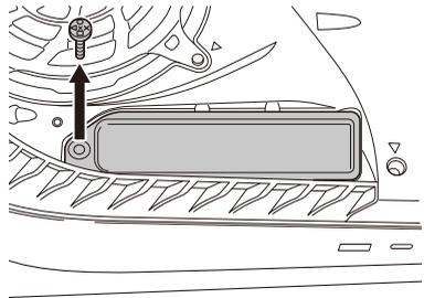
3. **Entfernen Sie die M.2-SSD-Montageschraube und die Zwischenscheibe, die an der PS5 angebracht sind. Hinweis: Achten Sie darauf, die Schraube und die Zwischenscheibe nicht zu verlieren.**
