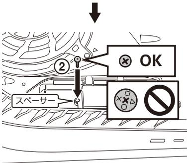
6 M.2 SSD拡張スロットのカバーの端をPS5本体に差し込み (③)、ネジ穴に合わせて押さえ、手順2で取り外したネジで固定します (④)。
