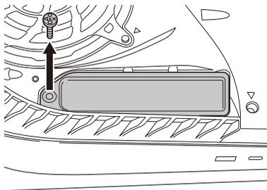
3. 卸下 M.2 固态硬盘的固定螺丝和附着在 PS5 上的垫环。
