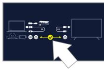
受信側機器に図のような画面が表示さ れ、画面中央部(イラストの矢印部) が「★」の場合は、接続準備中となり ます。接続されると「✔ | に変わりま す。
