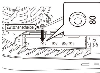
5. Achten Sie darauf, dass sich die Zwischenscheibe nicht bewegt, setzen Sie die SSD in den Anschluss des M.2-SSD-Erweiterungssteckplatz-Anschlusses ein (①) und richten Sie dann das dem Anschluss gegenüberliegende Ende mit dem Schraubenloch aus, halten Sie es fest und sichern Sie es mit der in Schritt 3 entfernten Schraube (②). Ein zu starkes Anziehen der Schraube kann die SSD oder den M.2-SSD-Erweiterungssteckplatz beschädigen.
