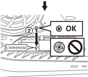
6. Insérez l'extrémité du couvercle du logement d'extension du M.2 SSD dans la PS5 (③), puis alignez le couvercle avec l'orifice de vis, maintenez-le en place et fixez-le avec la vis que vous avez retirée à l'étape 2 (④).
