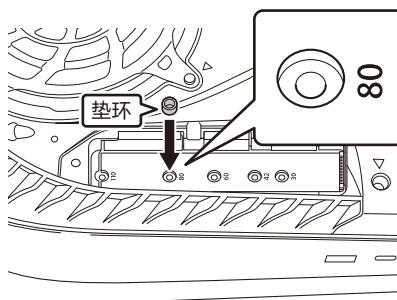
5. 把固态硬盘插入 M.2 固态硬盘拓展槽接口 (①), 注意不要挪动垫环的位置。把接口的另一边和螺丝孔位置对齐, 按下去, 用第 3 步中取下的螺丝固定位置 (②)。如果你把螺丝拧得太紧, 固态硬盘或者 M.2 固态硬盘拓展槽可能会受损。
